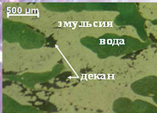
Микрофотография частично деструктурировавшей эмульсии в состоянии динамического запирания в ячейке Хеле-Шоу
