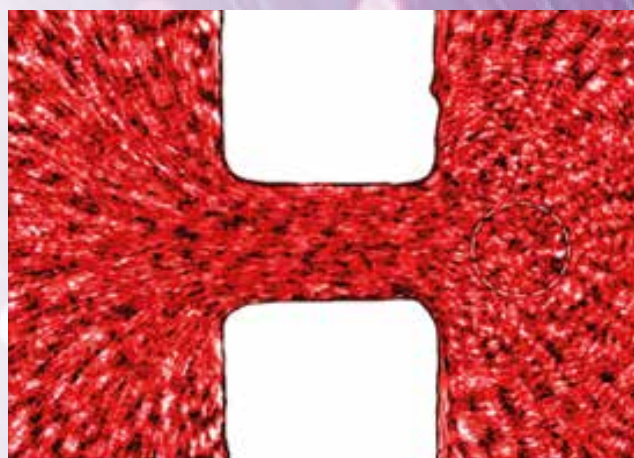
Цельная кровь, использовалось наложение двух последовательных кадров скоростной видеосъемки (7000 кадров/с)
